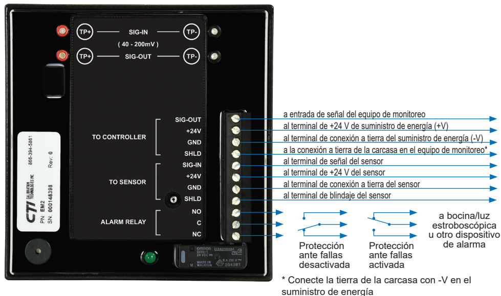
Figura 3: Diagrama de cableado (aplicación de paso)
