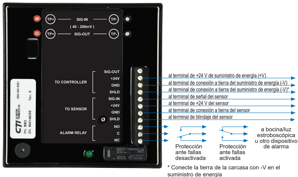
Figura 2: Diagrama de cableado (aplicación autónoma)
