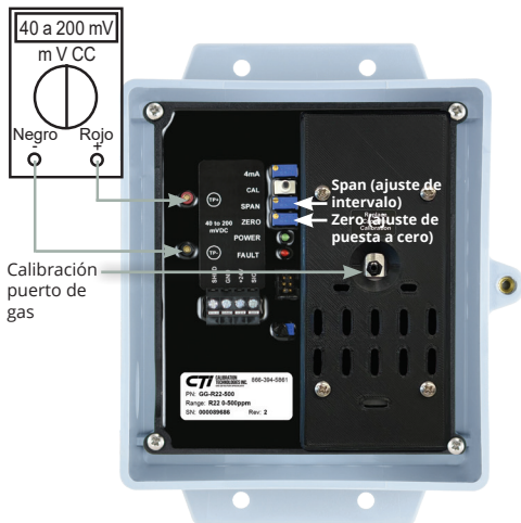
Figura 2: Componentes de la placa del sensor y ajuste de "zero/span"
